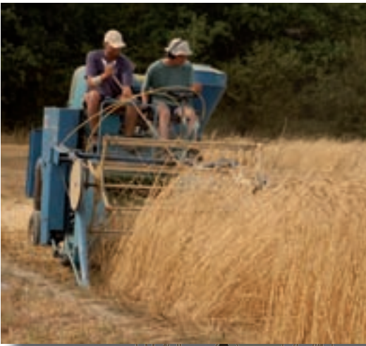
La batteuse de Triptolème, spécialement conçue pour la récolte d'essais car elle se nettoie très facilement
