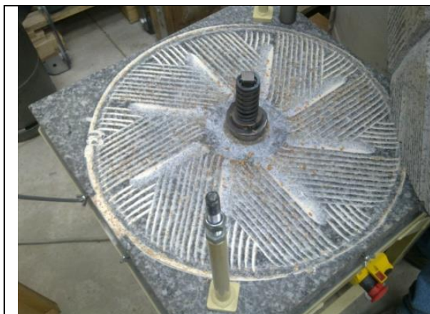
Figure 2 : Rayonnage de la meule gisante ou dormante
