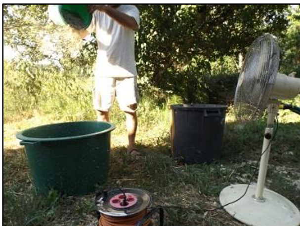
Figure 3 triage de graines de radis à l'aide d'un ventilateur chez Biau Germe
