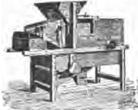
Fig. 71. — Tarare aspirateur insufflateur cribleur. (Rose frères, à Poissy.)
