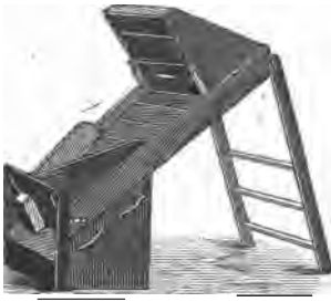
Fig. 74. — Cribleur nettoyeur pour avoine de consommation.
